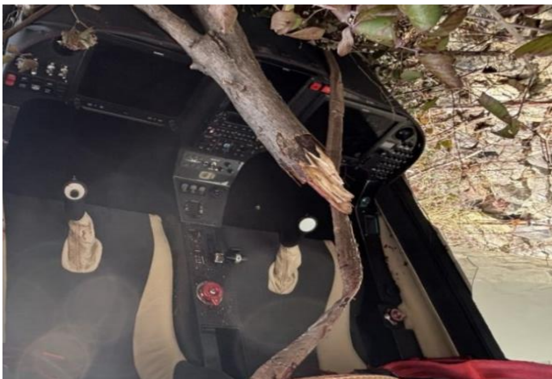
Foto 5: parte della struttura del cockpit dell'aeromobile, assenza dell'elemento trasparente in plexiglas.
