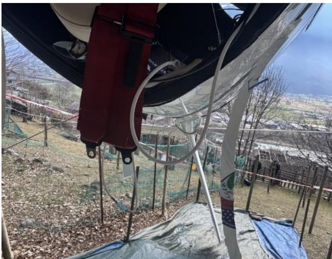
Foto 6: parte posteriore della cabina dell'aeromobile, assenza dell'elemento trasparente in plexiglas.
